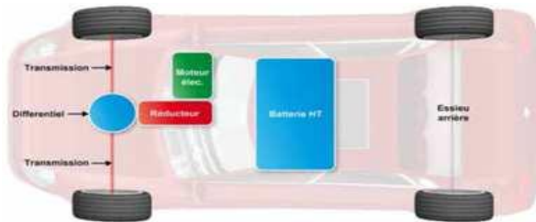
Figure .III.5 : Implantation des éléments d'une voiture électrique à traction avant.
