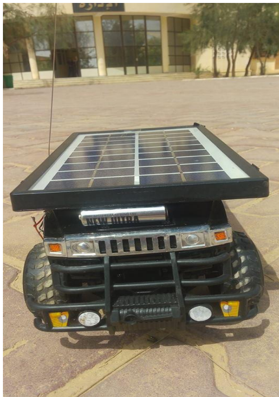
Figure .III.14 : voiture solaire avec Batterie Pb
