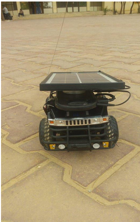
Figure.III.12 : voiture solaire avec Batterie Li-Po
