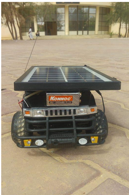
Figure .III.13 : voiture solaire avec Batterie Ni-Cd
