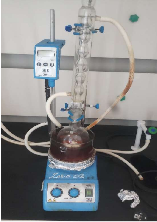
الشكل III.7 التقطير المرتد للسليولوز
