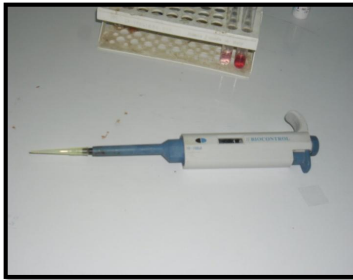
Figure 17 : Micropipette . BIOCONTROL-150µL (Photo personnelle., 2013)
