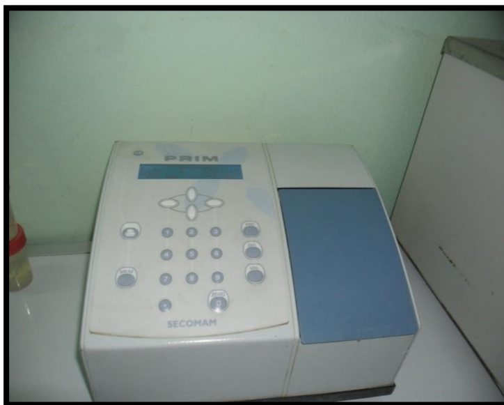
Figure 16 : Spectrophotomètre .PRIM SECOMAM (Photo personnelle., 2013)
