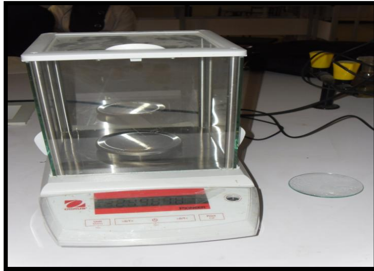
Figure 15: Balance analytique. KERAN (Photo personnelle., 2013)
