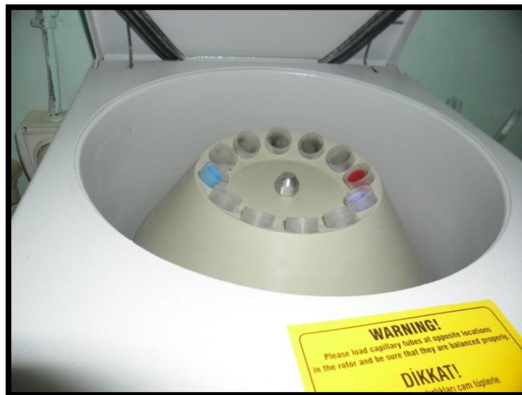
Figure 14 : Centrifugeuse .Model: NF200;Serial NO:02-4918 (Photo personnelle., 2013)
