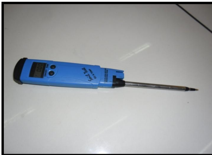
Figure 11 : Conductimètre HANNA(Photo personnelle., 2013)
