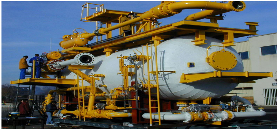
Figure III.1: Vue d'un séparateur triphasique
