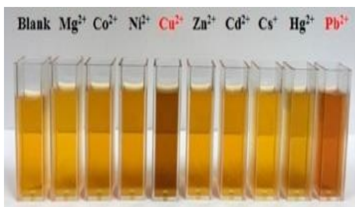
Figure 14 : Elaboration de capteurs de métaux lourds
