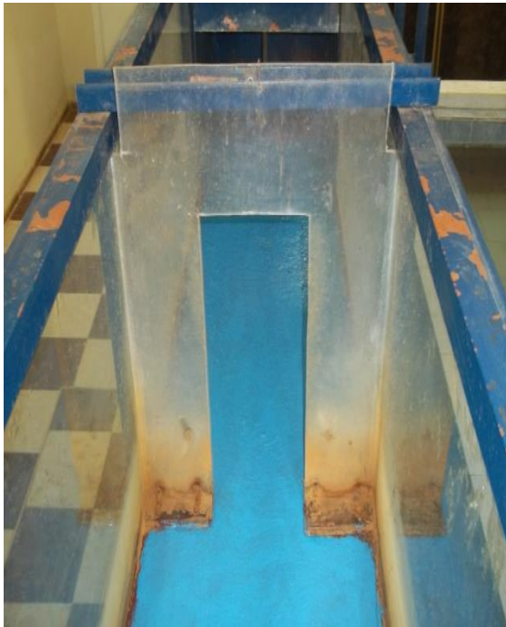
Photo 4.5 : Section de contrôle
