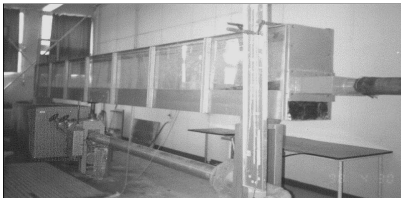
Photo 2.3: Dispositif expérimental ayant servi à l'étude du ressaut contrôlé
