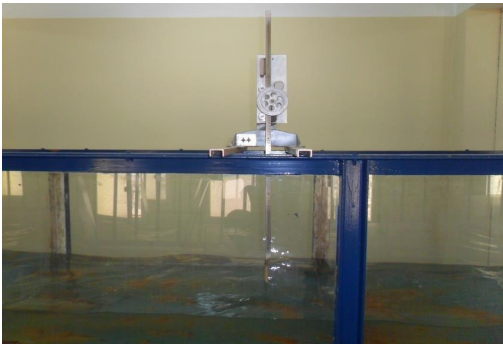
Photo 4.4 : Photographie du déversoir rectangulaire sans hauteur de pelle avec contraction latérale ayant servi à la mesure du débit
