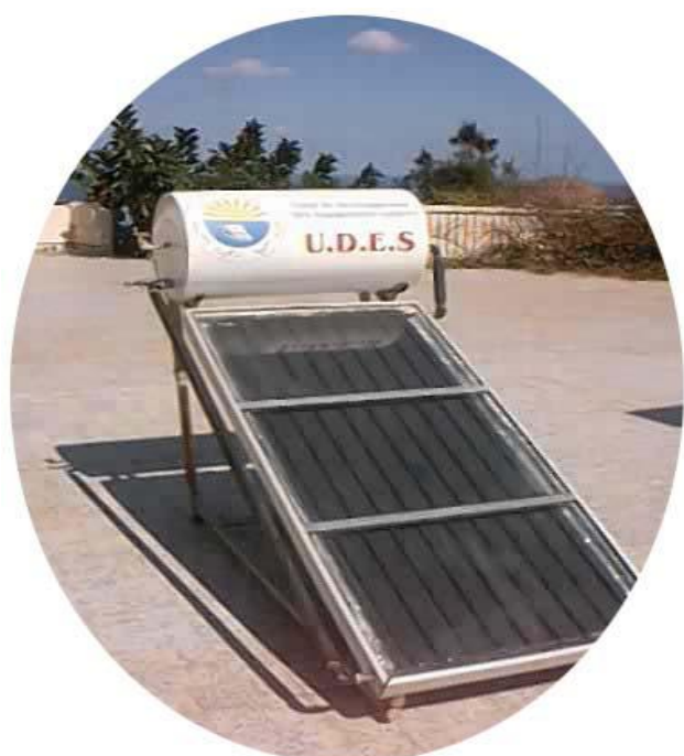
Figure II.16 : Chauffe eau solaire de L'UDES de 110L.
