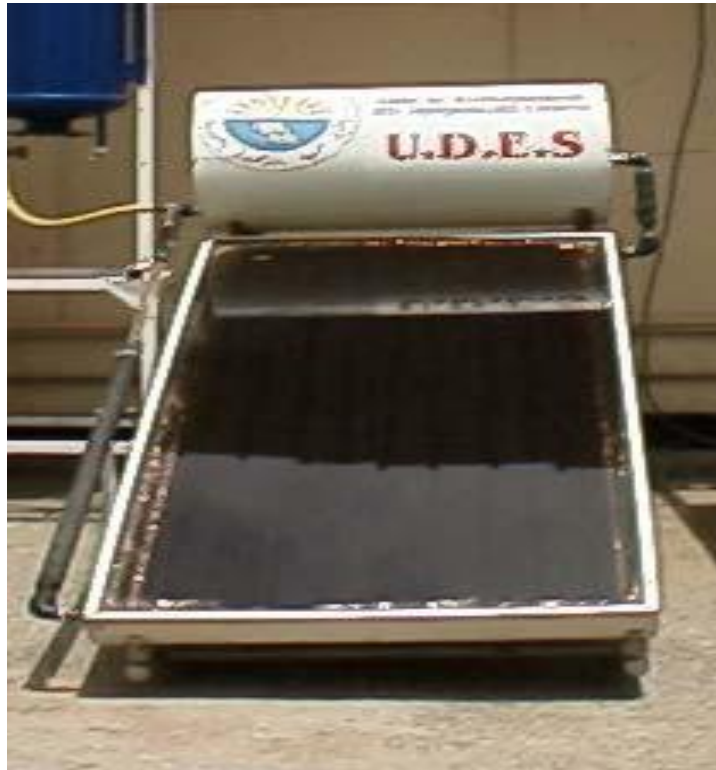
Figure II.3 : Chauffe eau solaire thermosiphon de 110 litres produit à L'UDES.
