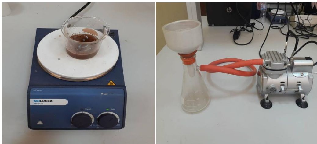
Figures II.5: Agitation des feuilles de palmiers dattiers et de leur filtration, puis mesure du pH.
