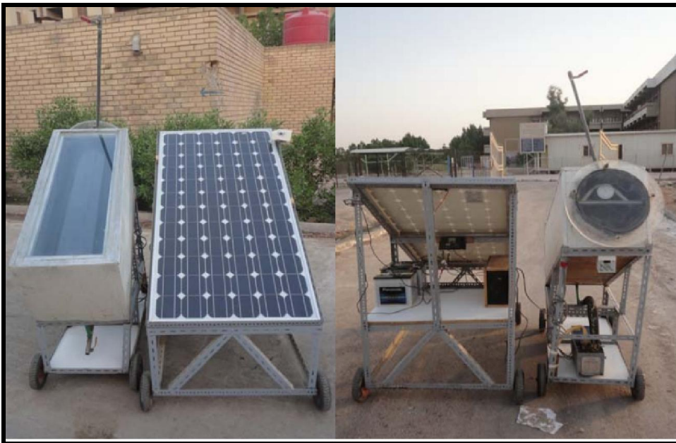
الشكل (I - 11): صورتان لمجفف شمسي للأسماك تحت التفرغ من الأمام و الخلف [29].
