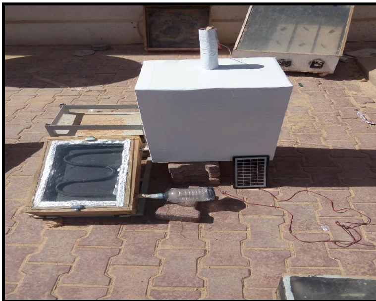
الشكل (III - 6) : التركيب التجريبي للمجفف الشمسي غير المباشر.
