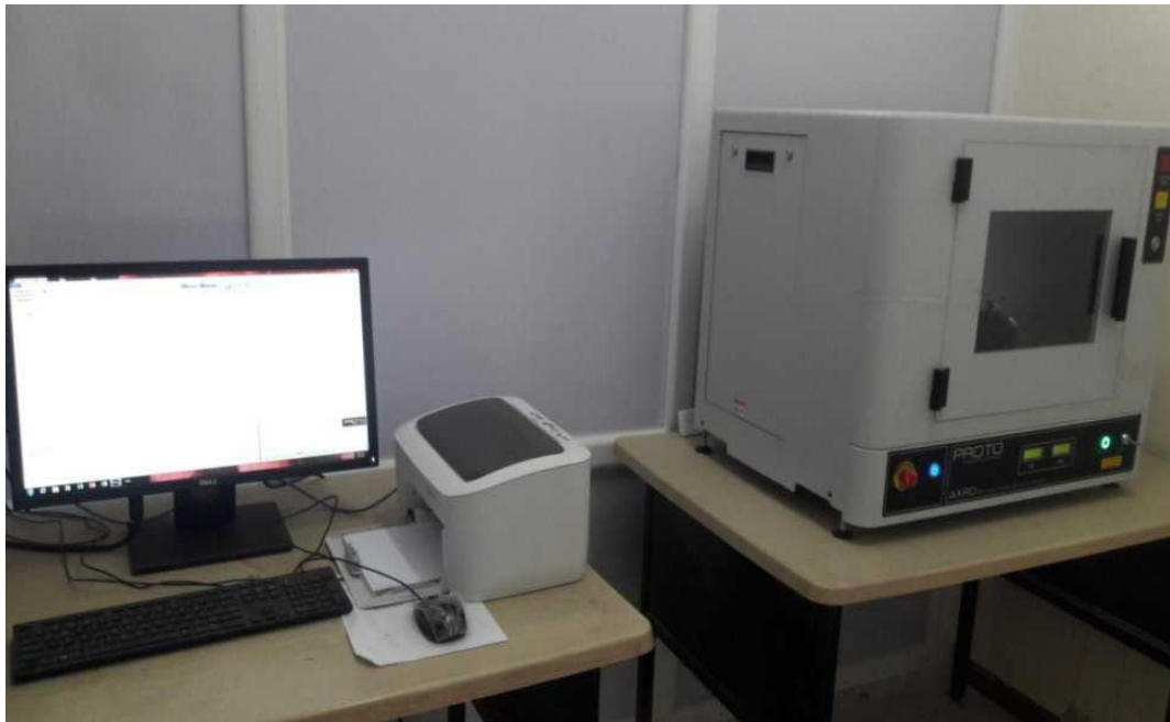
الشكل (2-9): صورة لجهاز انعراج الاشعة السينية المستعمل في دراسة العينات
