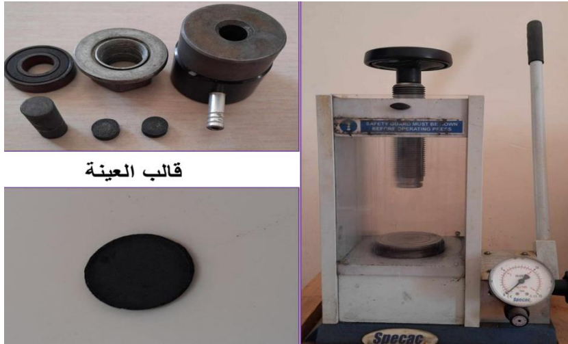
الشكل (3-12) آلة التقريص المستعملة
