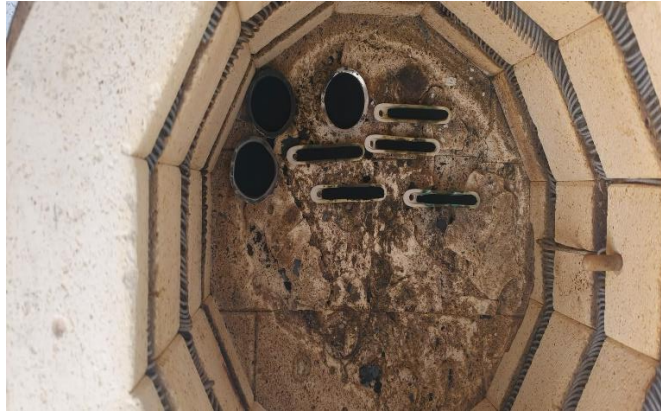
الشكل (3-6) وضع المساحيق في الفرن لعمليات الكلسنة
