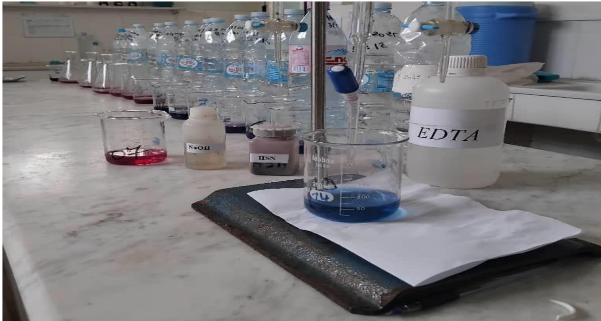
Figure 22 : Utilisation d'une solution d'acide éthylène-diaminetétra-acétique (EDTA) pour l'analyse de TH.
