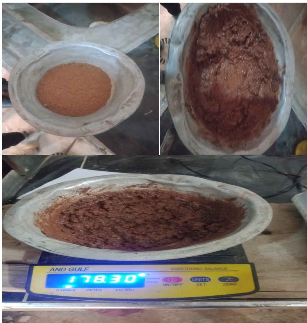
الملحق رقم 1: 2. صور توضح تجربة معامل امتصاص الماء.
