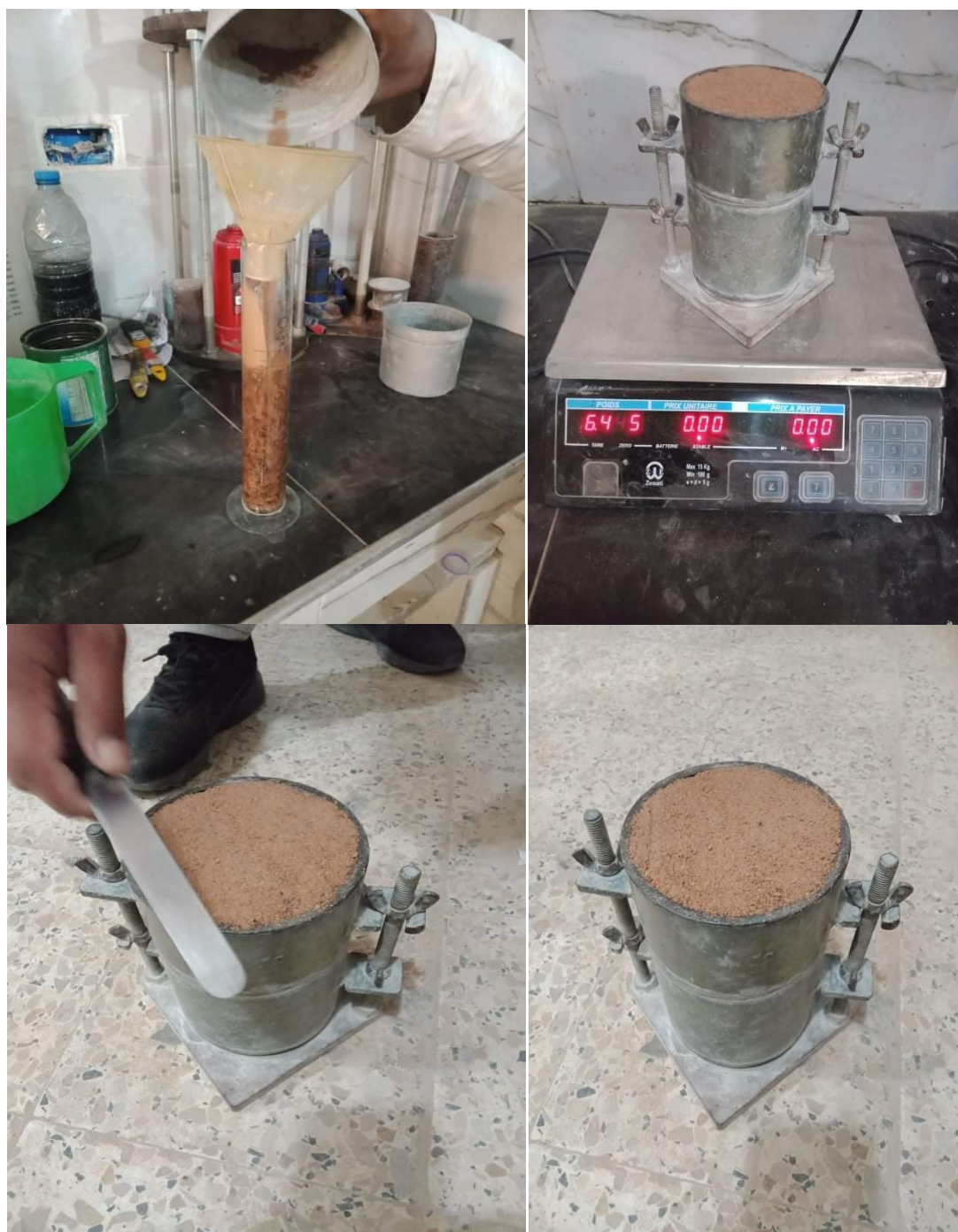
الملحق رقم: 1. 1. صور توضح تجربة الكتلة الحجمية
