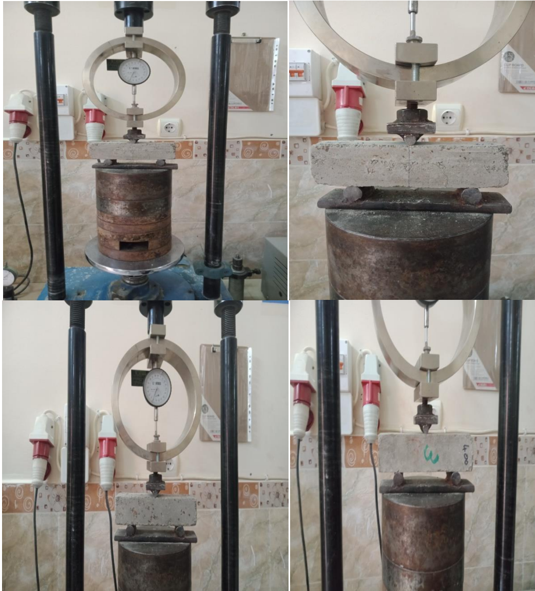
الملحق رقم 6. 1: صور توضح تجربة التحطيم بواسطة الانحناء.
