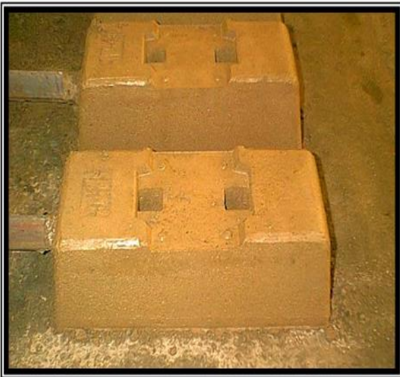
الصورة II. 2: العوارض بخرسانة الرمل مصنع بني صاف [16].
