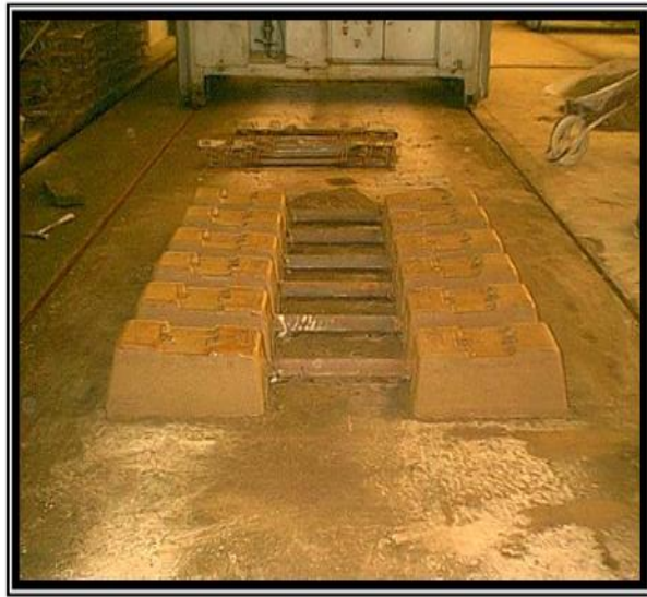
الصورة II. 2: العوارض بخرسانة الرمل مصنع بني صاف [16].
