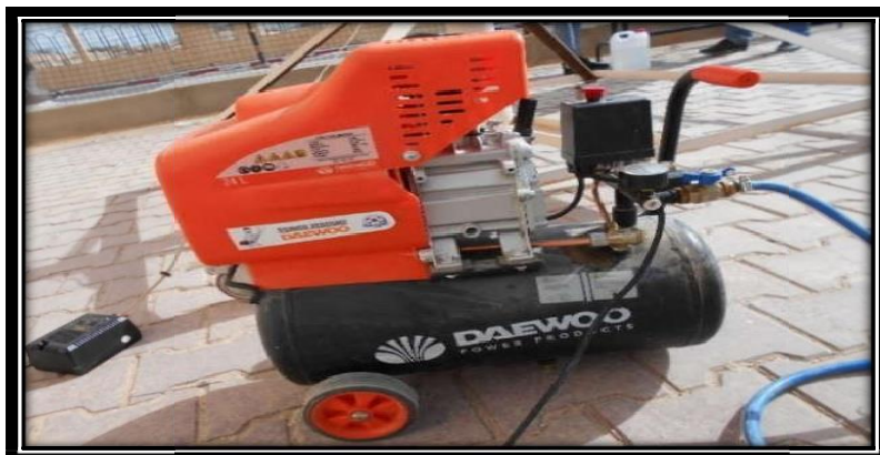
Figure II. 7 : Le compresseur utilisé pour augmenter la pression
