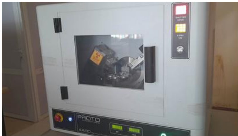
Figure II. 9 : Diffractomètre PROTO AXRD X-ray (laboratoire des matériaux organiques. Université Echahid Hamma Lakhdar).
