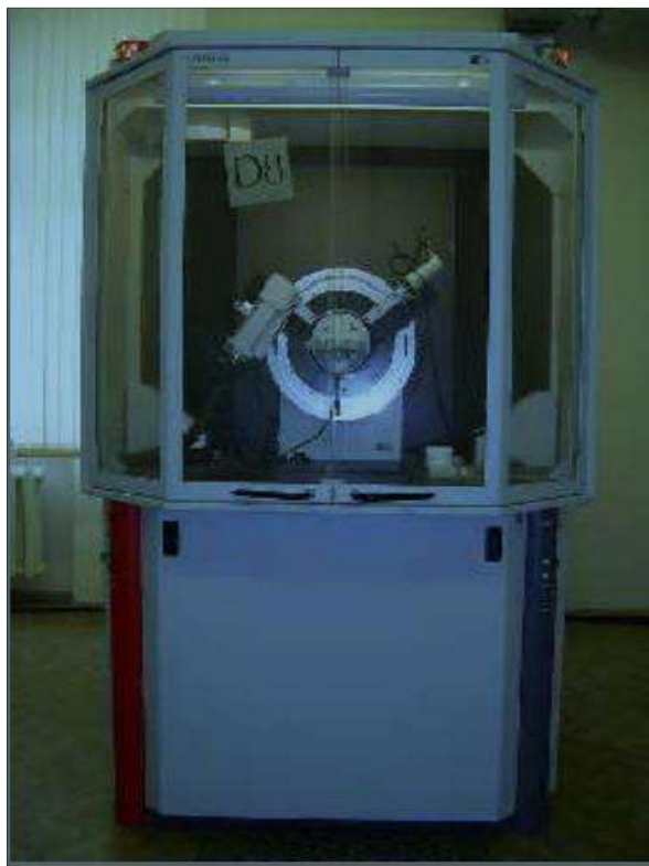
Figure (II.4) : Photo de dispositif de diffraction des rayons X (diffractomètre) [7].
