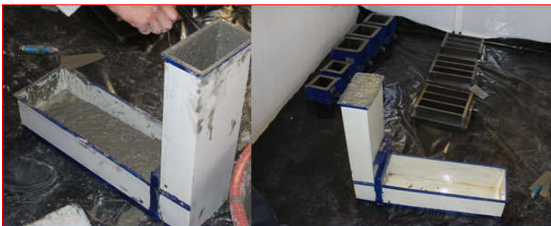
Figure IV.2 : Essai de la boîte en L
