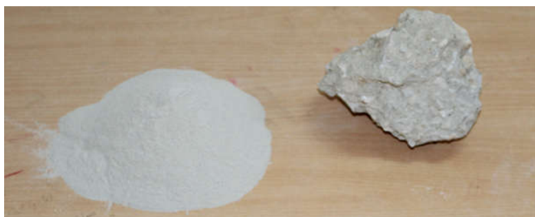
Figure II.13 : Déchets de béton.
