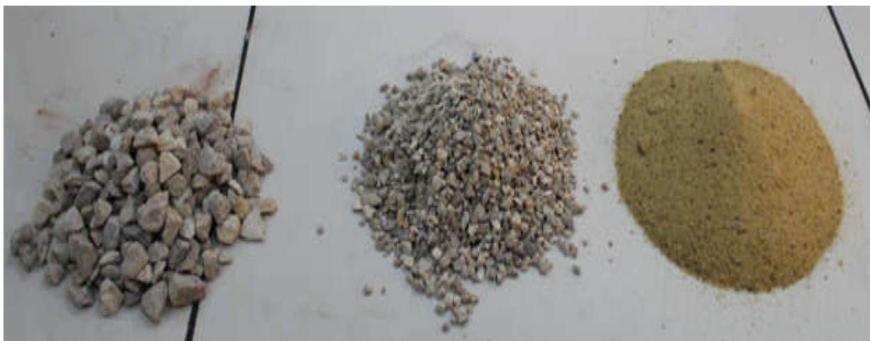
Figure II.1 : Echantillons de gravier 8/16 et de gravier 3/8 et sable 0/5
