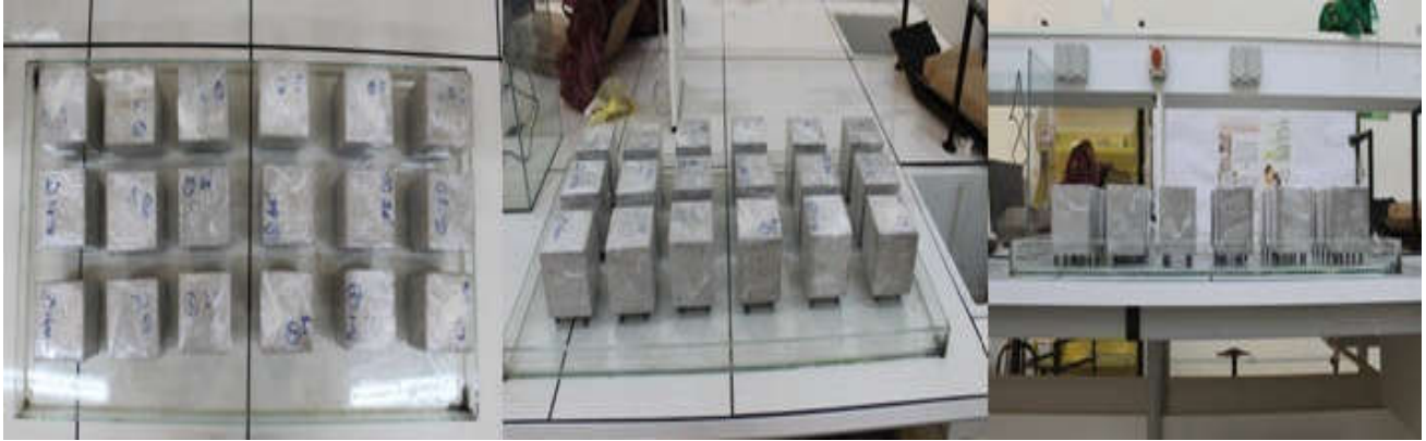
Figure IV.9 : Echantillons pour l'essai de l'absorption d'eau par capillarité
