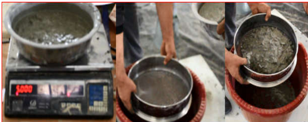
Figure IV.3 : Essai de stabilité au tamis
