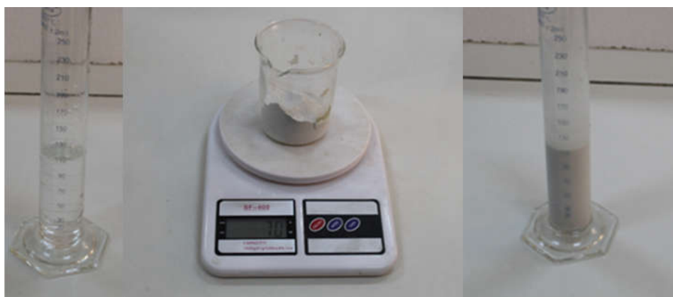
Figure II.17 : Exemple mesure la masse volumique absolue
