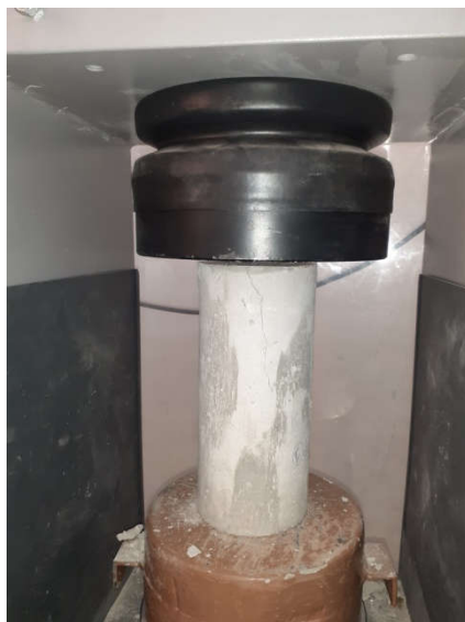
Figure IV.5 : l'éprouvette sous la compression
