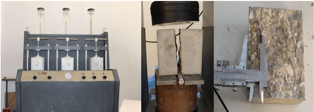
Figure IV.12 : Etapes de l'essai de Perméabilité du béton
