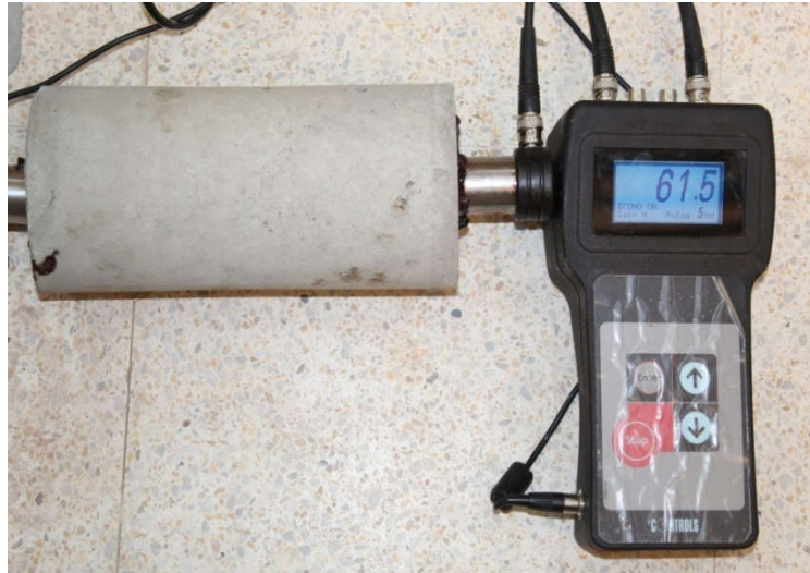
Figure IV.19 : Essai d'auscultation sonique
