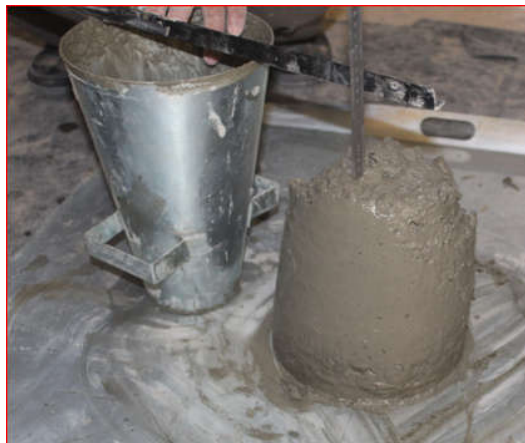
Figure IV.1 : Essais de l'affaissement au cône d'Abrams BO
