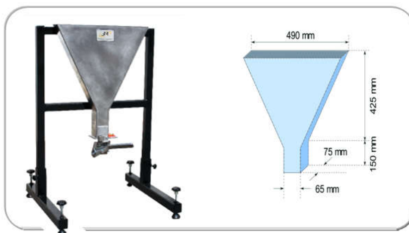
Figure I.7 : L'essai de l'écoulement à l'entonnoir (V-Funnel)
