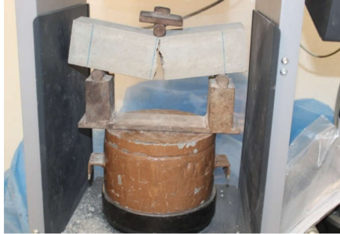
Figure IV.7 : Échantillon sous l'essai de traction par flexion
