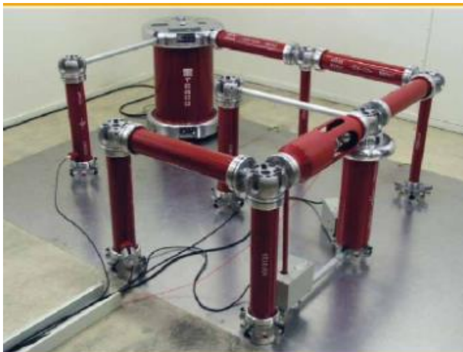
Figure III.4 Photo du circuit d'essai à fréquence industrielle
