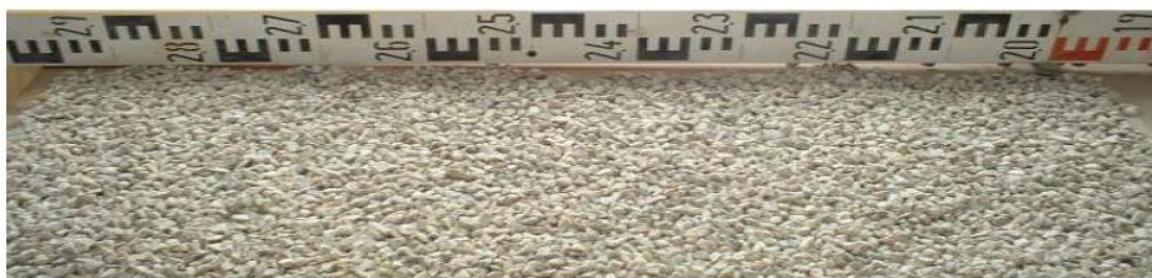
Photographie 4.1, Echantillon de Toile Rugueuse de Rugosité absolue \varepsilon = 8,73 mm
