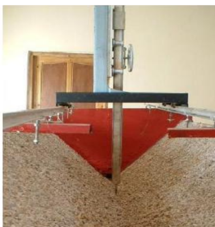
Photographie 4.2, Toile Rugueuse Soigneusement Collée sur les deux parois du Canal Triangulaire
