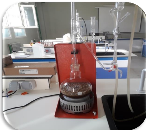
Photo 08 : Dispositif de Clevenger pour l'extraction de l'huile essentielle.
