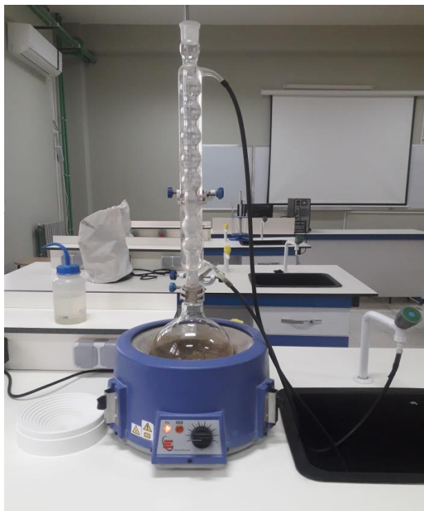
Photo 02 : Dispositif de reflux pour l'extraction de l'extrait aqueux
