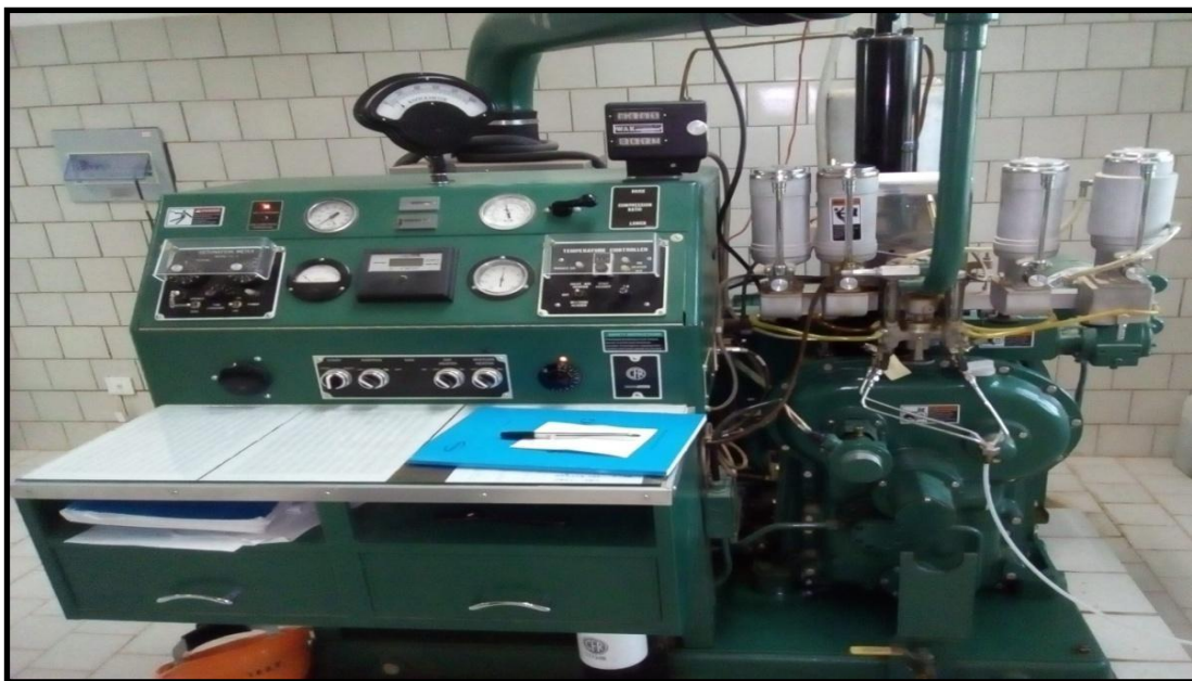
Figure IV.2. Moteur monocylindrique (CFR) [12].
