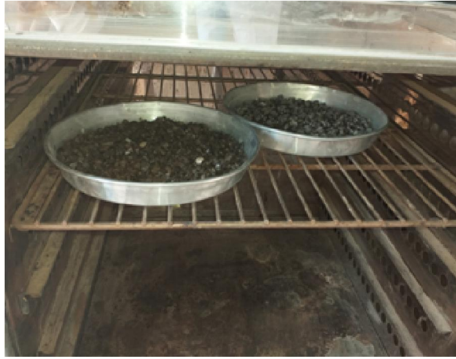
صور (III - 2) تجربة امتصاص الماء للحصى
