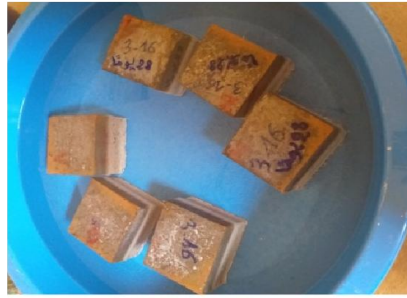
عينات في محلول H_2SO_4 بتركيز 1%
