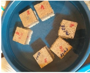
عينات في محلول H_2SO_4 بتركيز 3%
