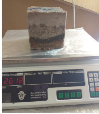
صور (V-5) توضح العينات المهاجمة من قبل حمض Hcl قبل الغسل
