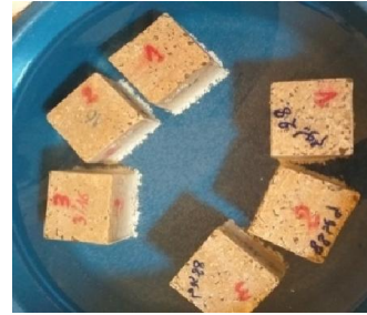
عينات في محلول H_2SO_4 بتركيز 7%
