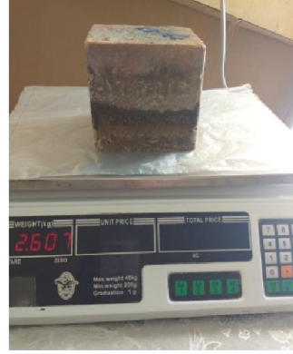
صور (V-5) توضح العينات المهاجمة من قبل حمض Hcl قبل الغسل
