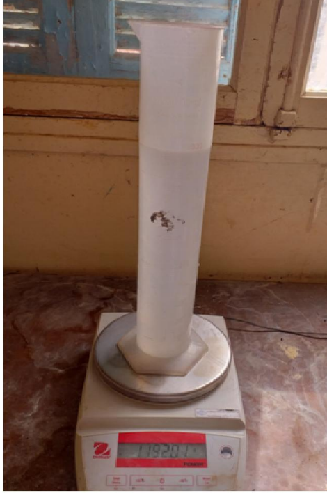
صور (III - 5) تجربة الكتلة الحجمية المطلقة للرمل
