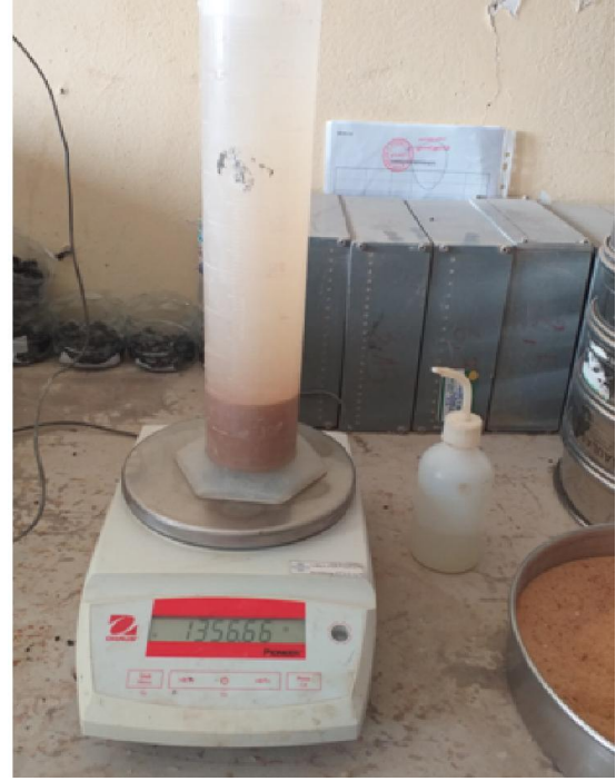
صور (III - 5) تجربة الكتلة الحجمية المطلقة للرمل
