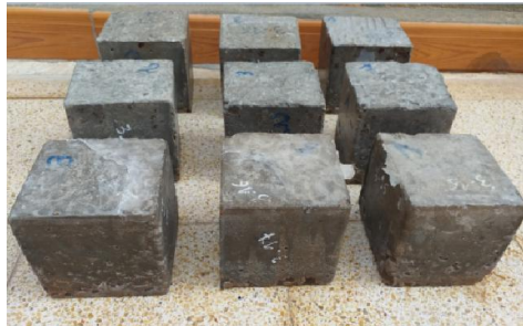
صورة (V-8) توضح العينات المهاجمة من قبل حمض Hcl بتراكيز مختلفة
