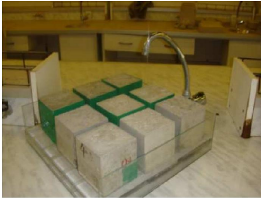
صورة ( IV - 3 ) تجربة امتصاص الماء
