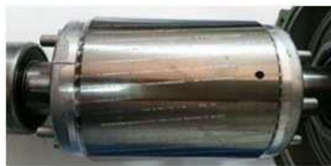
Figure I.14 Rotor de la machine à induction avec une barre cassée
