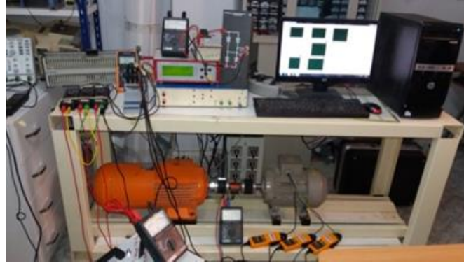
Figure II.1 Banc d'essai expérimental dédié aux défauts d'excentricité
