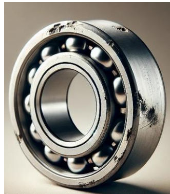
Figure IV.3 Roulement défectueux (défauts sur sa bague extérieure)
