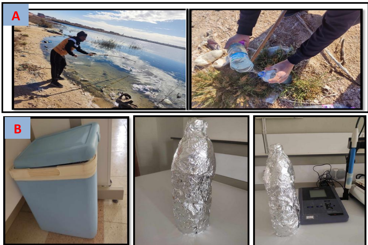
Photo 10 :A -Prélèvements des échantillons d'eau ; B-Conservation des échantillons (Kelkami et Hachem, 2024)
