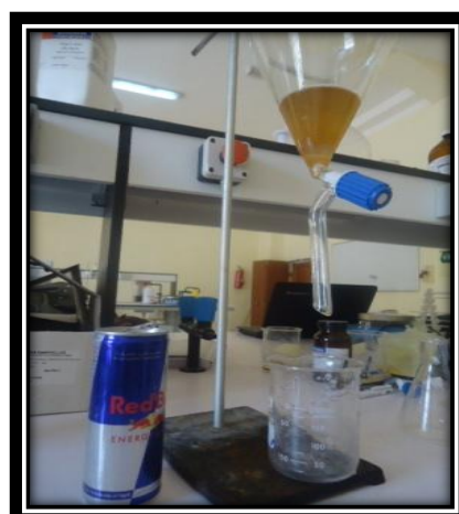
الشكل (2.3): استخلاص الكافيين من المشروب بواسطة الكلوروفورم
