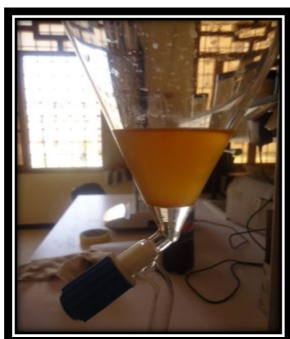
الشكل (2.3): استخلاص الكافيين من المشروب بواسطة الكلوروفورم
