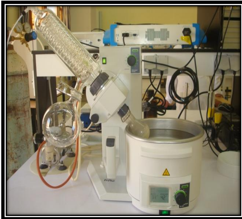
الشكل (4.3): فصل الكلوروفورم عن الكافيين بواسطة المبخرة الدوارة
