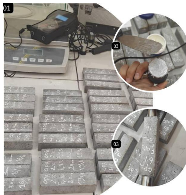
Figure II.20. Mesure de la vitesse d'impulsion ultrasonique .
