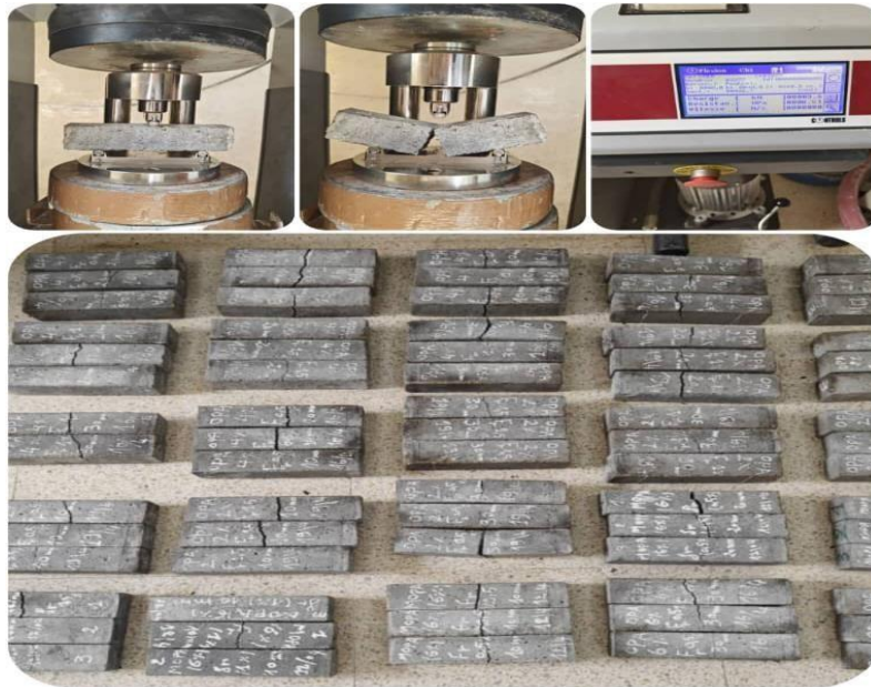
Figure II.23. Essai de flexion par trois points sur éprouvettes prismatiques.
