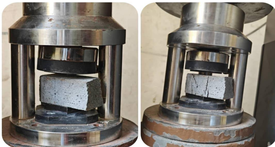
Figure II.24. Eprouvettes soumises à l'essai de compression avant et après rupture .
