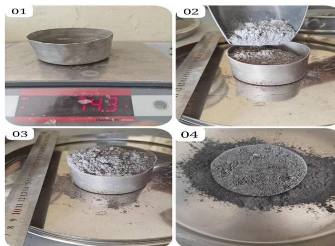
Figure II.16. Étapes de l'essai de la masse volumique apparente (OPA).
