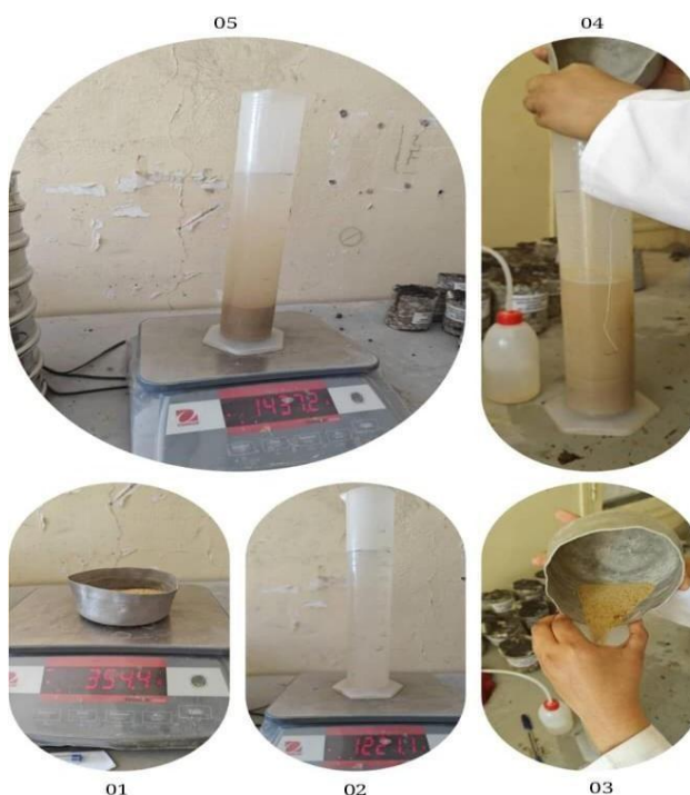
Figure II.15 . Étapes de l'essai de la masse volumique absolue.
