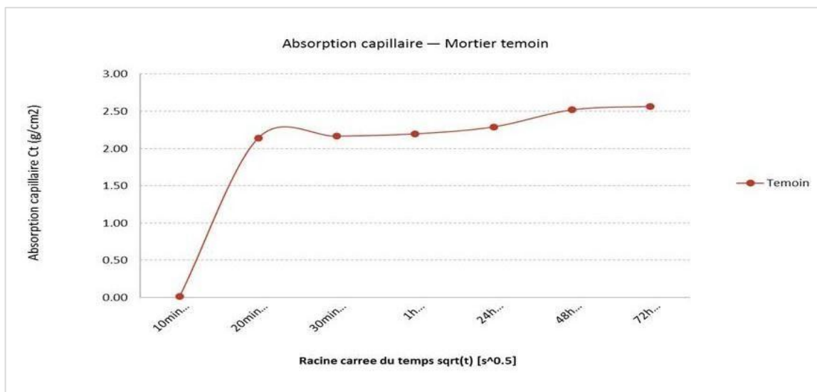
Figure III.9a. Cinétique d'absorption capillaire du mortier témoin .
