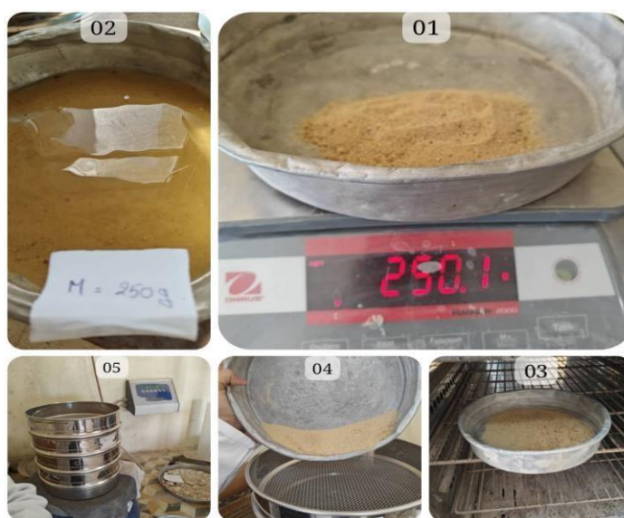
Figure II.12. Étapes de l'essai d'analyse granulométrique.
