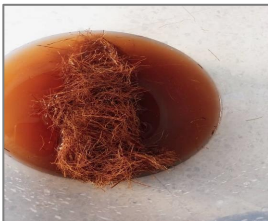
Figure II.9. Lavage des fibres à l'eau du robinet.
