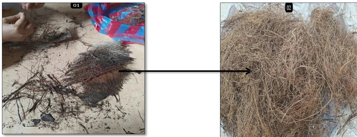
Figure II.8 . Séparation des fibres de palmier dattier.
