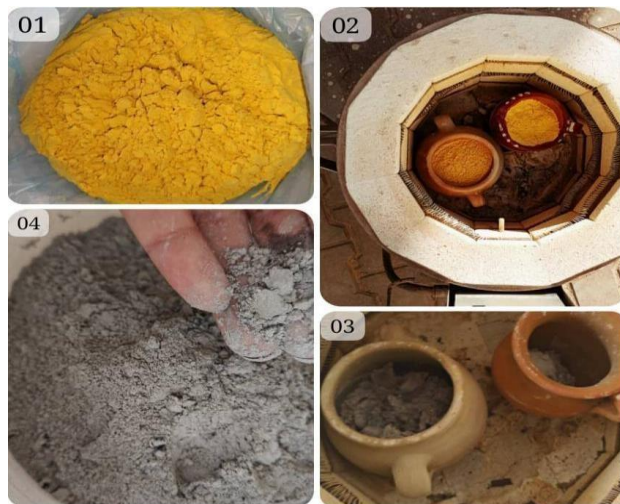
Figure II.4 . Étapes du traitement thermique de la poudre d'écorces d'orange..
