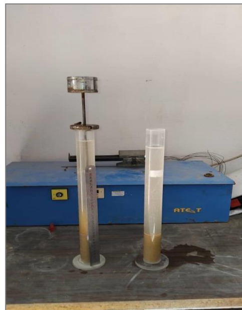
Figure II.12. Éprouvettes de l'essai d'équivalent de sable.
