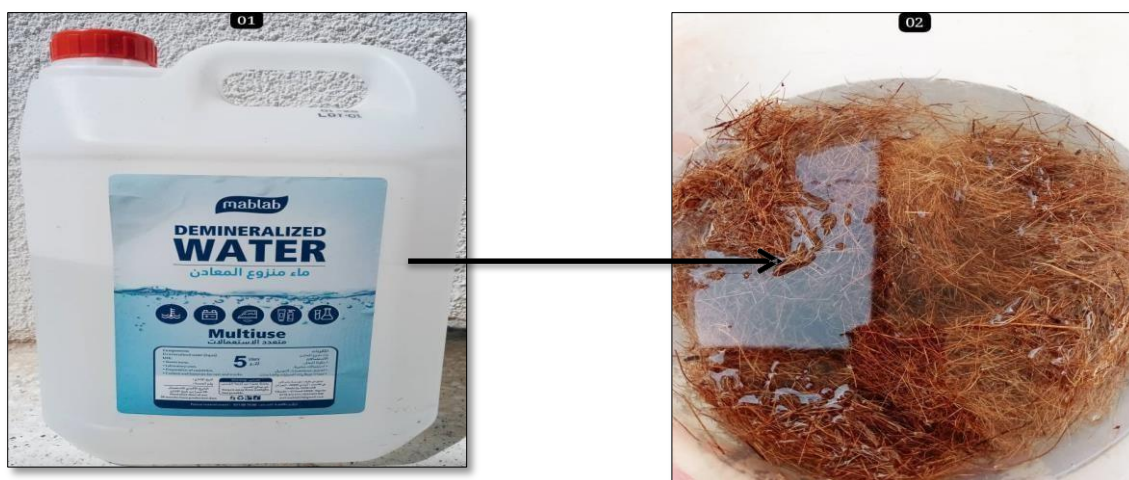
Figure II.10 . Lavage des fibres à l'eau distillée .
