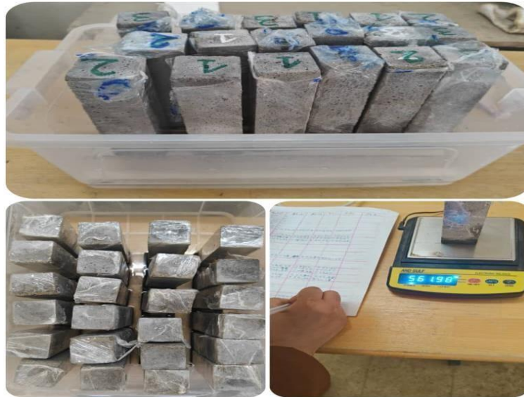
Figure II.22. Image du test d'absorption capillaire.
