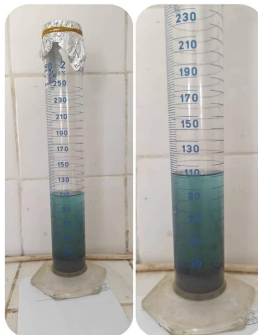
Figure II.17. Essai de la masse volumique absolue de l'OPA par la méthode de déplacement de liquide.
