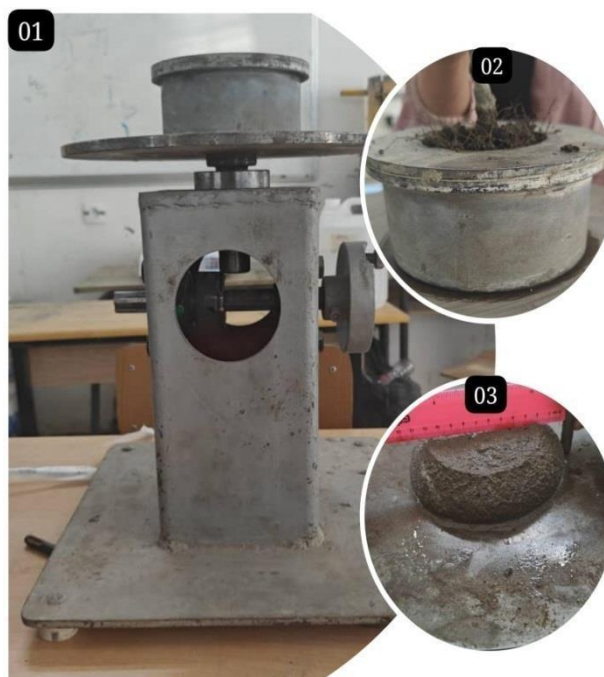
Figure II.19. Essai d'étalement à la table à secousses .
