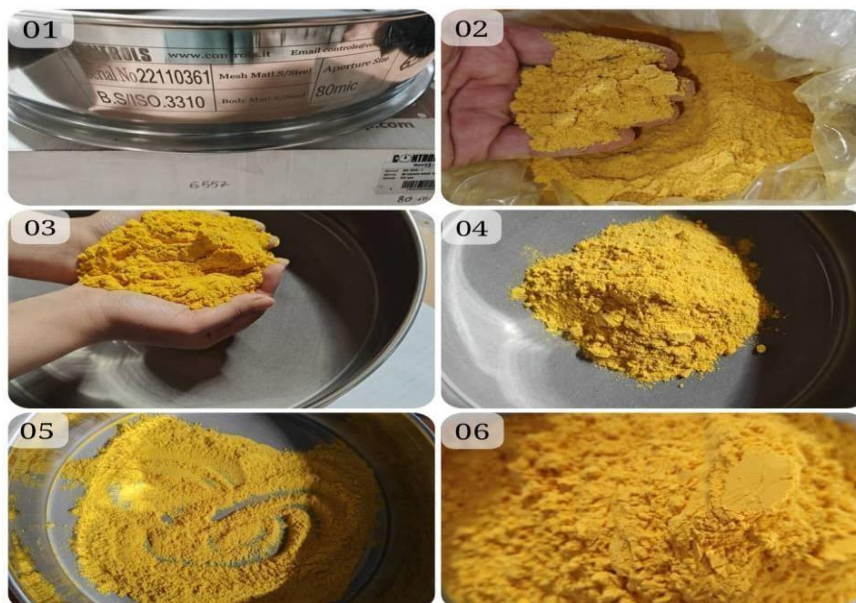
Figure II.3 . Étapes de tamisage du poudre d'écorces d'orange à l'aide d'un tamis normalisé (80 \mu m).
