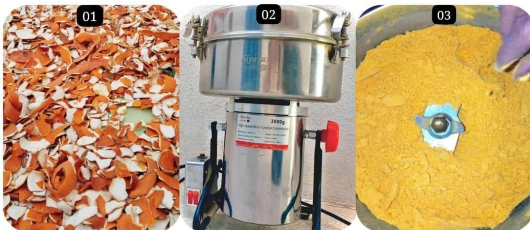
Figure II.2. Étape de broyage des écorces d'orange séchées en poudre fine.
