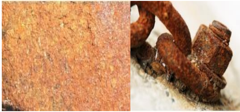
Figure 8 : Exemples de corrosion uniforme. [04]
