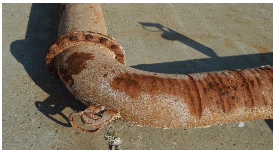
Figure 5 : Image d'un tuyau rouillé causé par l'eau de mer canalisation dans un environnement marin [09]
