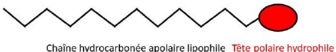
Figure 11: Schéma d'une molécule tensioactive (Lafforgue,2010).
