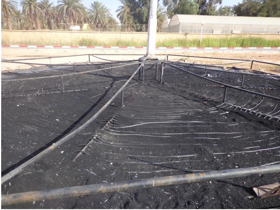
Fig. (V.14) : Image d'une couche de granules de caoutchouc noir de 0,1 m.
