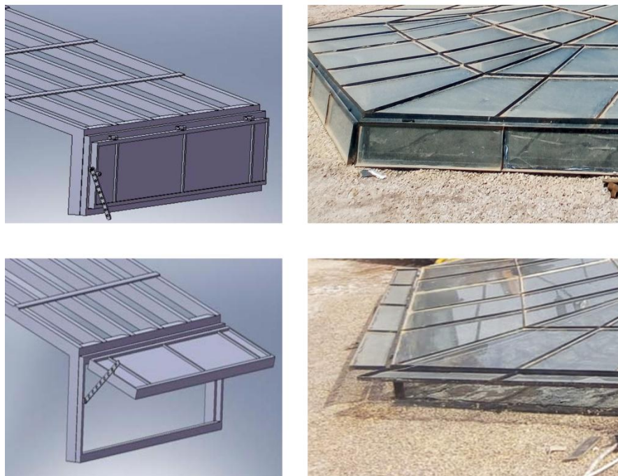
Fig. (V.4) : Conception des couvercles appliqués à l'entrée du collecteur.
