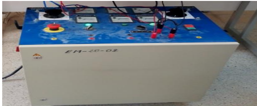
Fig.IV.1 : Source d'alimentation 380v
