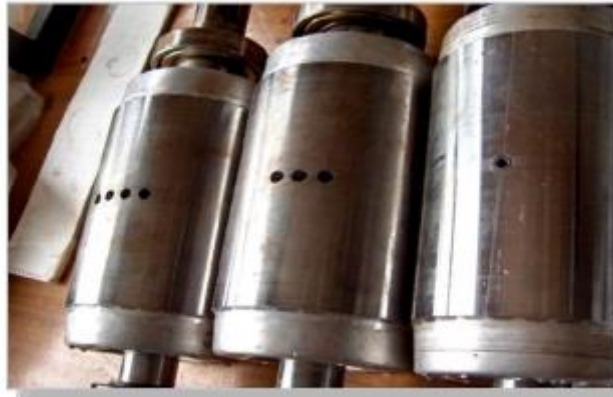
Fig. I.11: Défaut de rupture de barresv[2].
