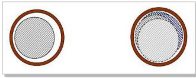
Fig. I.7: Défauts d'excentricité statique et dynamique[5].
