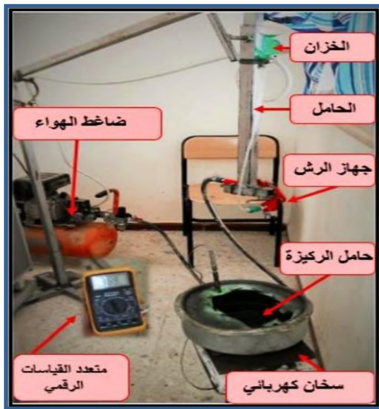
الشكل (1-III): التركيب التجريبي لجهاز الرش بالانحلال الكيميائي الحراري.
