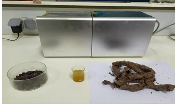
الوثيقة 45: صورة توضح استخلاص الزيت الثابت بجهاز المكبس الحلزوني
