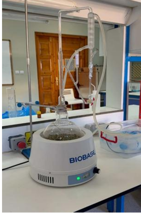
الوثيقة 44: صورة توضح استخلاص الزيوت الطيارة بجهاز الكليفنجر
