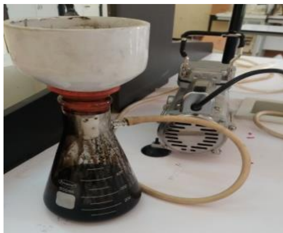
Figure III.7 Filtration sous vide
