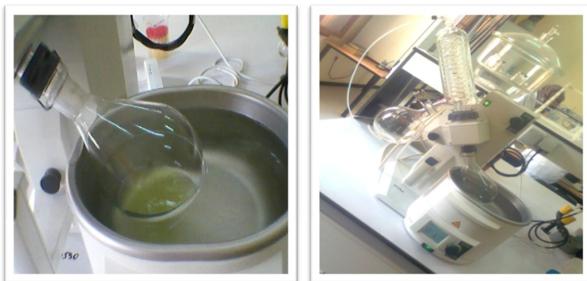
Figure 43 : Extrait des plantes utilisées dans le Rotor vapeur
