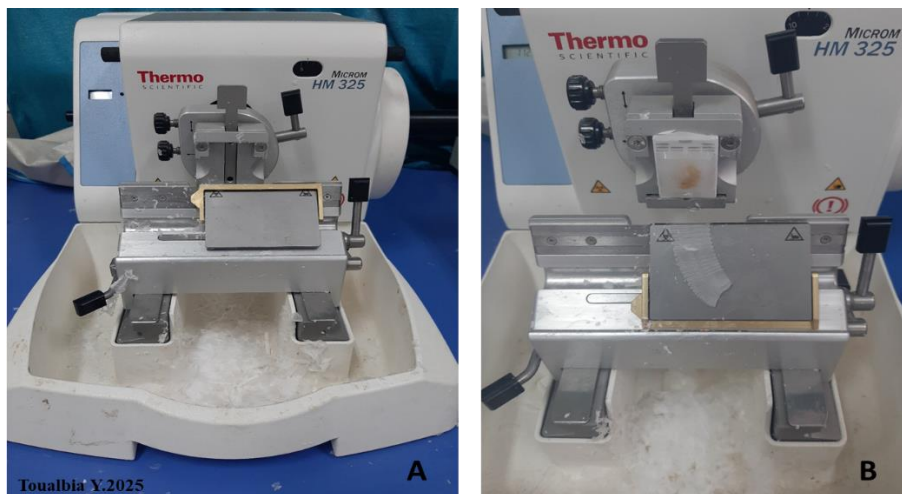
Figure 29. Microtome rotatif semi-automatique utilisé pour la coupe des blocs de paraffine ; Vue générale de l'appareil avant l'insertion du bloc de paraffine (A) ; Bloc de paraffine fixé dans le porte-bloc (B) (Originale).
