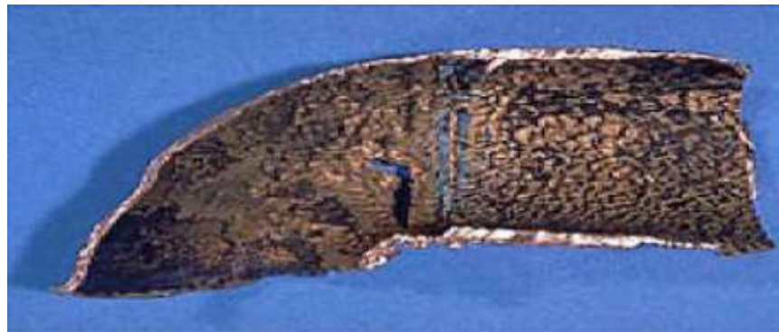
Figure I.9 : Étapes de développement du phénomène de corrosion-érosion [28].
