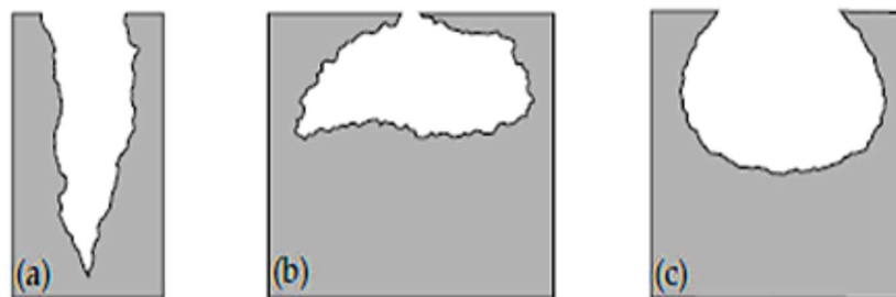
Figure I.5 : Formes de piqûres (a) cavité profonde (b) cavité cavernieuse (c) hémisphérique [36].
