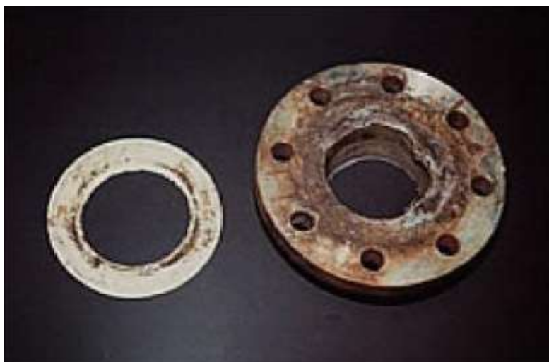
Figure I.7 : Corrosion caverneuse d'un acier allié sous un joint [38].
