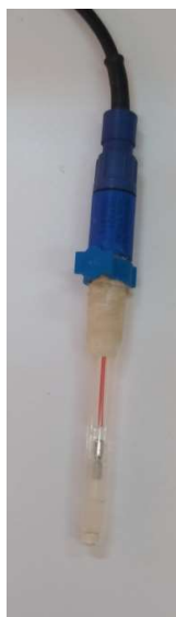
Figure.II.3 : Electrode de référence
