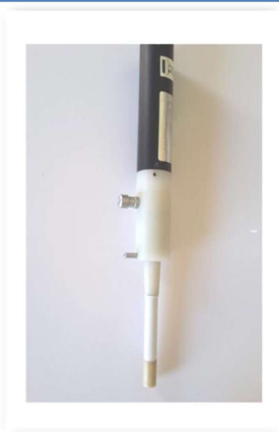
Figure.II.5 : Electrode de travail
