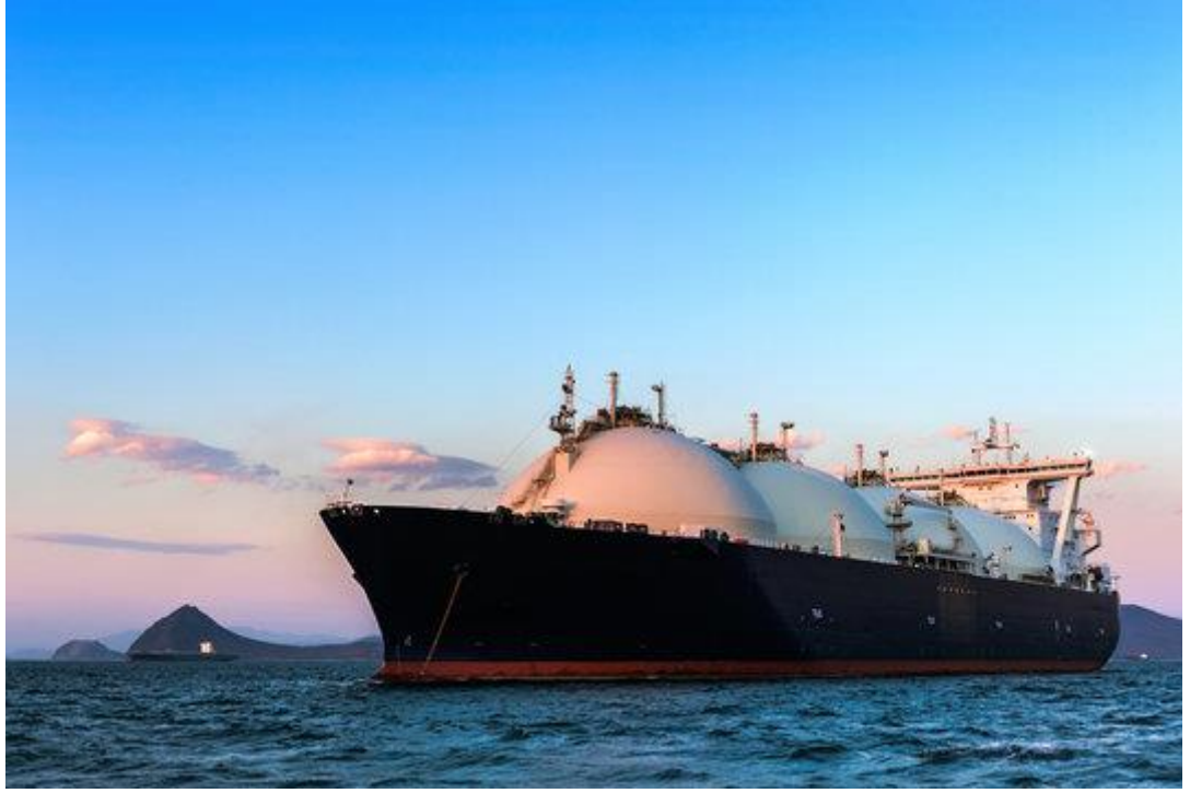
الشكل (1.3): ناقلة الغاز الطبيعي المسال (LNG) ذات الخزانات الكروية.
