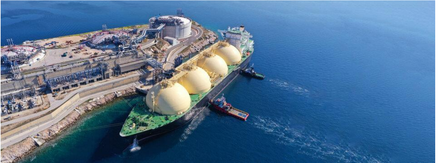
الشكل (2.3): تمثل هذه الصورة عملية تفريغ الغاز الطبيعي المسال (LNG) في محطة استقبال ساحلية
