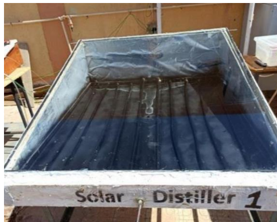
الشكل I-8: مقطر شمسي بداخله أنابيب من النحاس [12]
