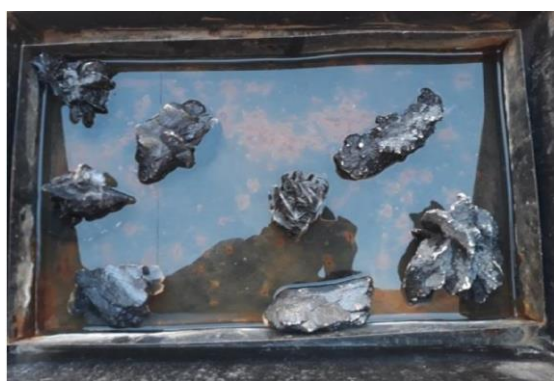
الشكل I-9: مقتر شمسي بداخله حجاره زهرة الرمال [13]
