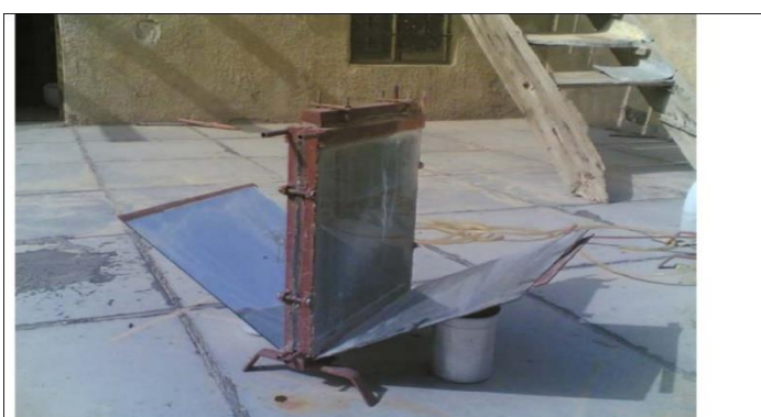
الشكل II-25 : يوضح صورة المقطر شمسي العمودي لجانين مع المرآة العاكسة [17]
