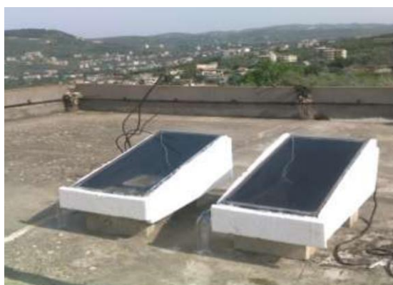
الشكل I-2: المقطرين الشمسين المصنعين أحدهما مزود بمادة متغيرة الطور والثاني من دون مادة متغيرة الطور. [4]
