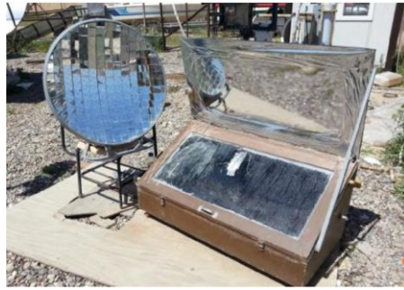
الشكل: I-7 مقطر شمسي مضاف اليه لوح عاكس ومركز شمسي [10]
