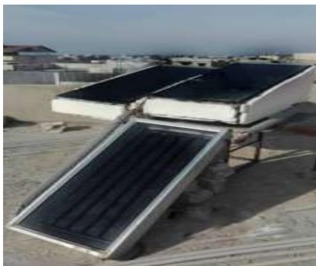
الشكل I-3: المقطران الشمسيان المصنعان أحدهما مزود بلاقط شمسي والثاني دون لاقط شمسي. [5]
