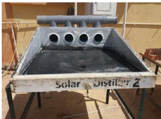
الشكل I-4: طريقة ربط مبخر المضخة بخلية التقطير [7]
