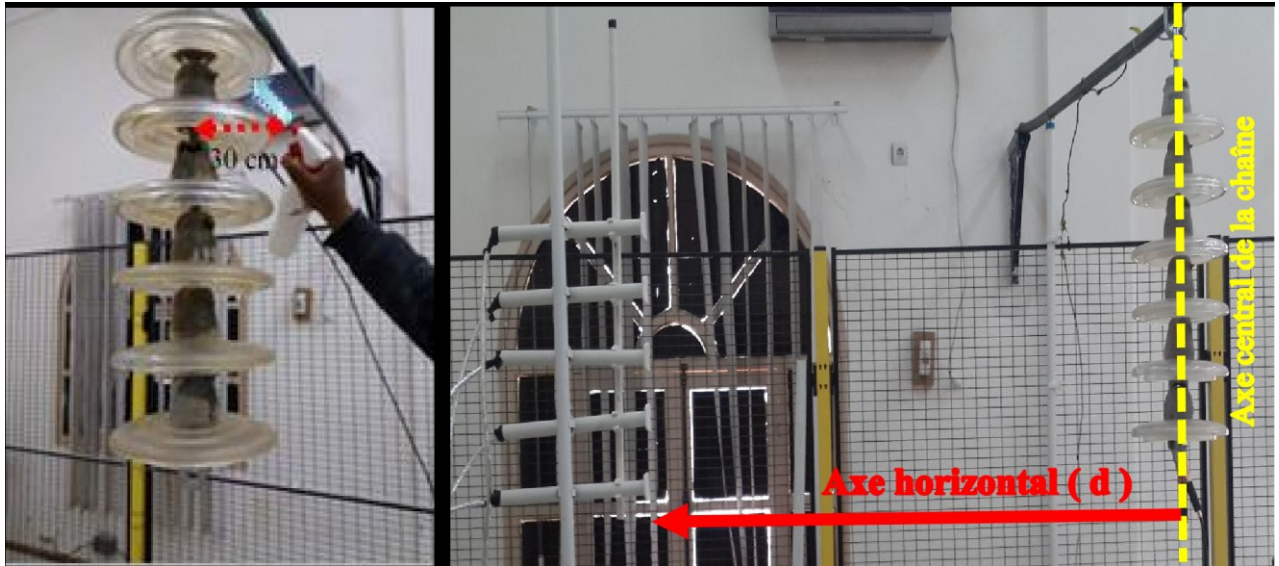
Figure I.2. Méthode de pulvérisation , Figure I.3. La chaîne des isolateurs utilisée et les pulvérisation axes de mesure du champ
