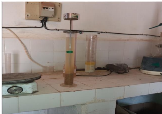
Figure 3 : Equivalent de sable.
