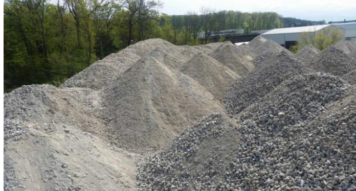
Figure 1 : Déchets de béton.
