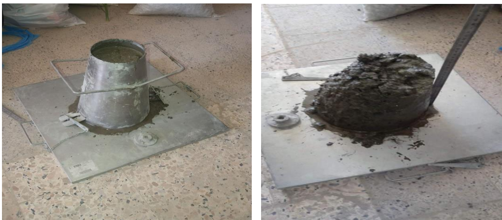
Figure 7 : Essai de cône d'Abrams.
