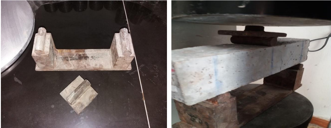
Figure 2 : Essai de traction par flexion.
