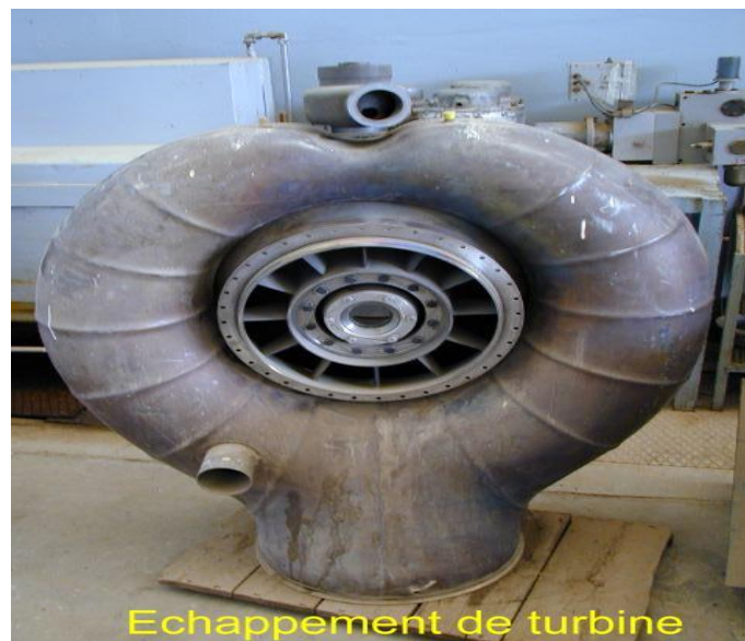
Fig.II.9:Echappement de turbine
