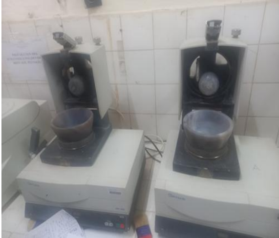
Figure 06 - Broyage des échantillons (préparation de la finesse du produit inférieur à 80 microns)
