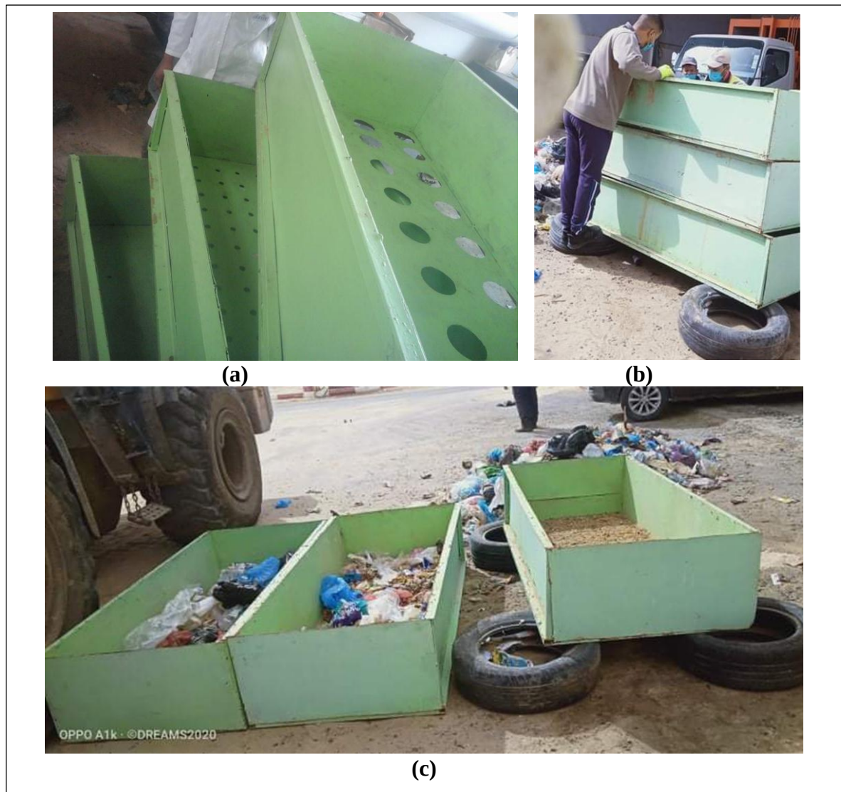
Figure 11: Table de tri utilisé au niveau CET, (a) la table vide, (b) mise des déchets et tamisage, (c) après tamisage et séparation par taille (photos originales, 31-03-2021). Nous avons trié par taille et par catégories 64 kg de DMA frais. (Figure 12)
