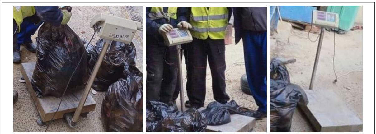
Figure 12 : Plate- forme de pesée électronique utilisée au niveau du CET (photos originales 07/04/2021)
