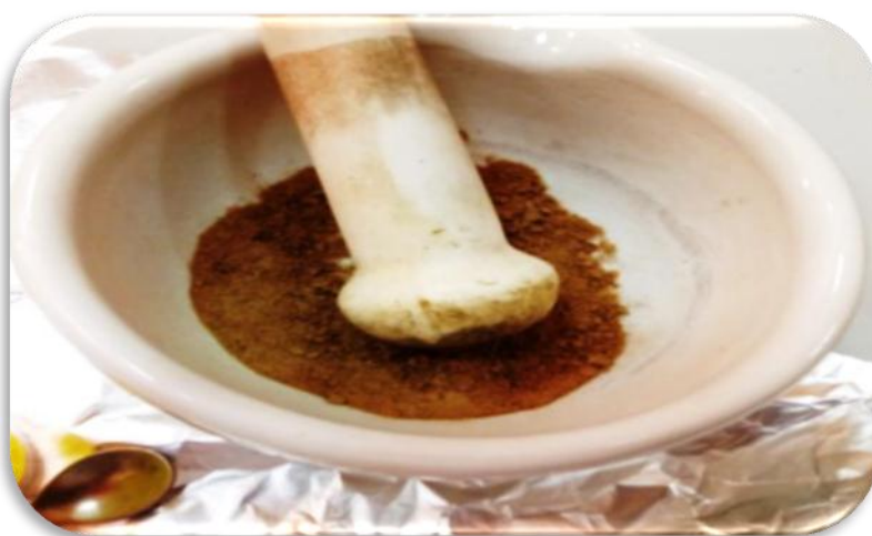
Figure III.7: Rebroyage de la fibre végétale
