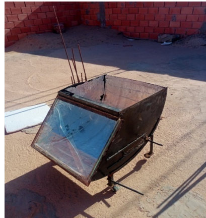
الشكل(III-3): صورة للمجمع الشمسي للمجفف ذ والماص المقلوب.
