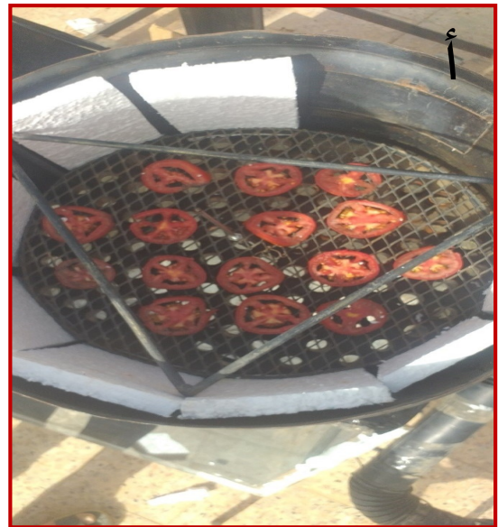
الشكل (III-26): صورة العينات على مستوي المجففين أ) الغرفة ذات الزعانف ب) غرفة بدون زعانف.
