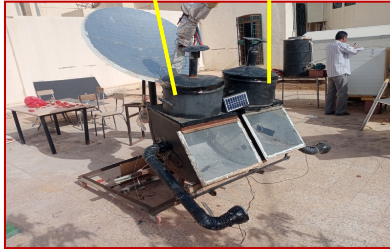
الشكل (III-25): صورة وضع المجففين على المحور الدوار.
