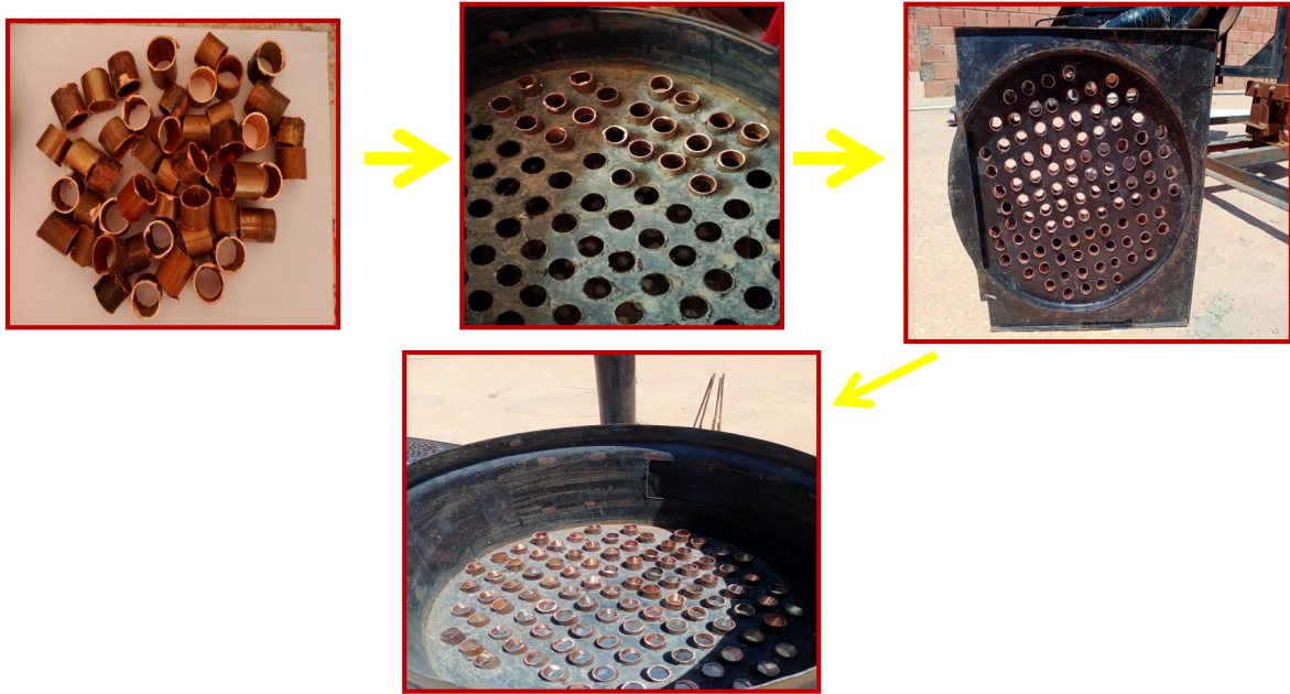
الشكل (III-24): مراحل تثبيت الاسطوانات النحاسية على احد غرف التجفيف.
