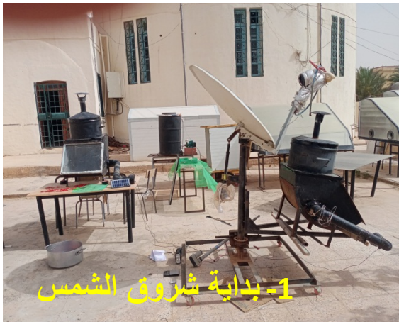
الشكل (III-17): ضبط اتجاه المجفف الدوار باستمرار للحفاظ على الزاوية المثلى نحو الشمس خلال ساعات النهار
