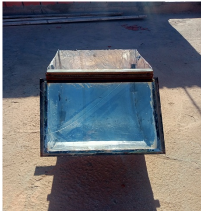
الشكل(III-3): صورة للمجمع الشمسي للمجفف ذ والماص المقلوب.
