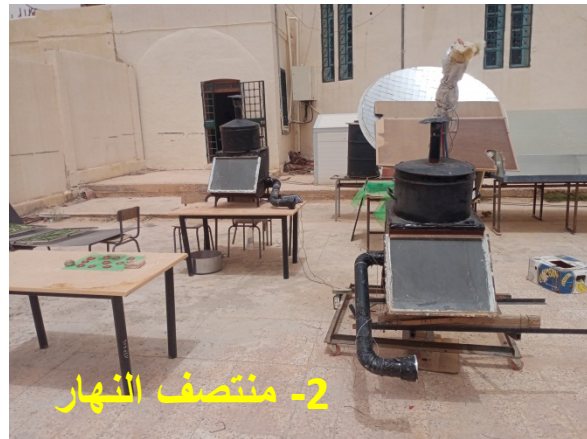
الشكل (III-17): ضبط اتجاه المجفف الدوار باستمرار للحفاظ على الزاوية المثلى نحو الشمس خلال ساعات النهار
