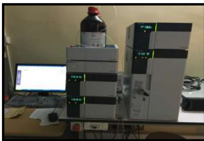
الشكل (III-4) : جهاز كروماتوغرافيا السائلة عالية الأداء (HPLC).
