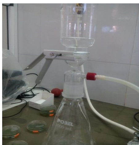
Photo 11.- Montage de filtration
