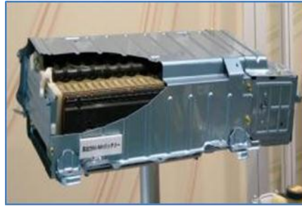
Figure II.4. Batterie Ni-Mh d'une Toyota Prius seconde génération. [14]
