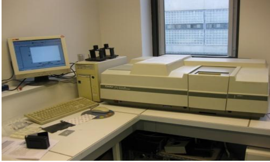
الشكل (8.II): الجهاز مطيافية امتصاص UV-Vis-PIR CARY 2415 .
