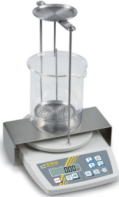
الشكل (2.II): الميزان الإلكتروني (KERN) لقياس الكثافة.
