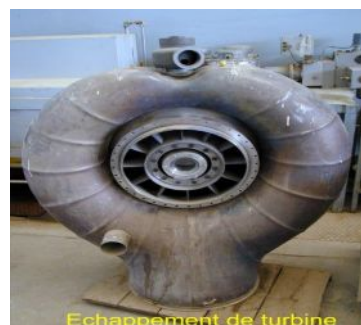
Figure I-6 Echappement d'une Turbine à Gaz
