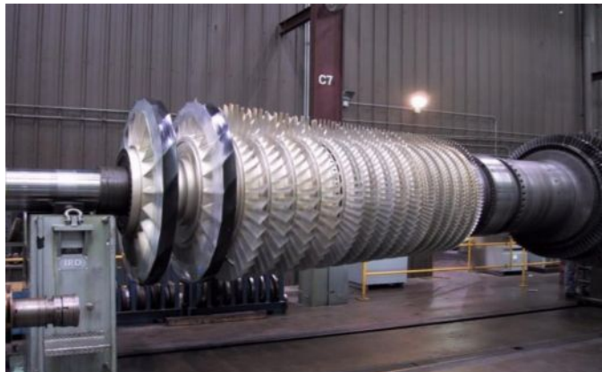
Figure I-5 Rotor d'une Turbine à gaz
