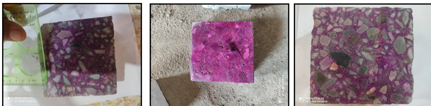
Figure V-23 Etat des éprouvettes aux différents types du bétons après pulvérisant une solution phenolphthaleine
