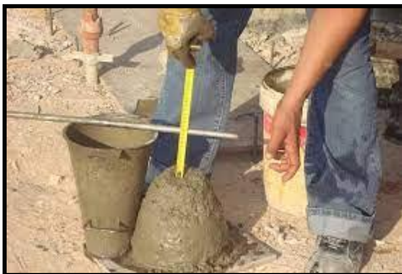
Figure (V-1) Essai d'affaissement au cône d'Abrams
