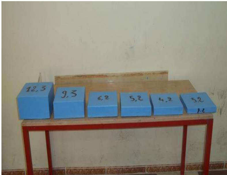
Photo 4.5 : Photographie des seuils épais testés
