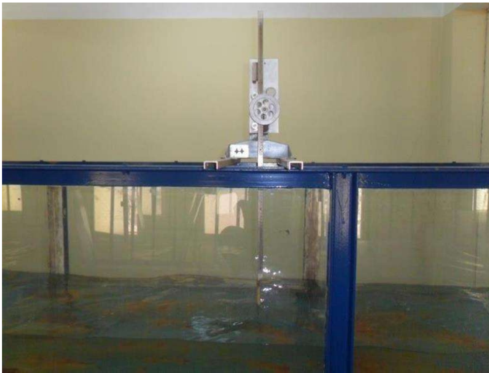
Photo.4.3: Photographie du déversoir rectangulaire sans hauteur de pelle avec contraction latérale ayant servi à la mesure du débit
