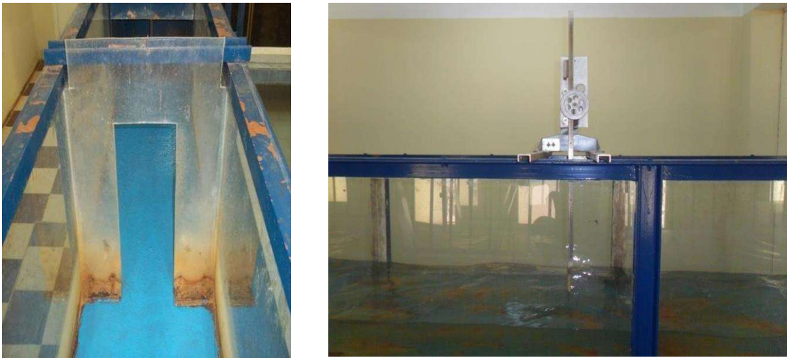
Photo.4.7 : Photographie du déversoir rectangulaire sans hauteur de pelle avec contraction latérale ayant servi à la mesure du débit
